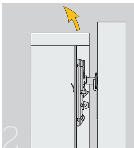
Desmontaje: Regular en profundidad al máximo para desenclipar el antivuelco y descolgar el mueble
