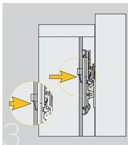
Montaje: Primero regular en altura hasta la posición deseada, luego en profundidad y empujar el antivuelco para encliparlo
